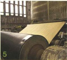
Asciugatura Il foglio di carta creatosi viene per fasi successive "strizzato" con l'ausilio di presse e rulli e, quindi, asciugato con l'aggiunta di calore.
